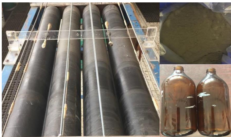
Figura 3. Sistema empleado para realizar proceso de cianuración.
