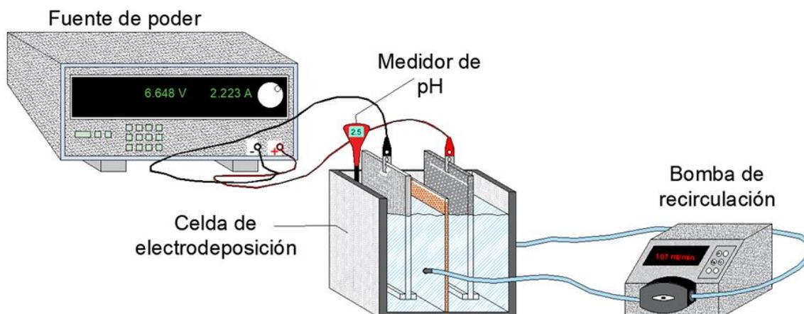
**Figura 1. Representación del sistema electroquímico para las pruebas de electrodeposición.**
