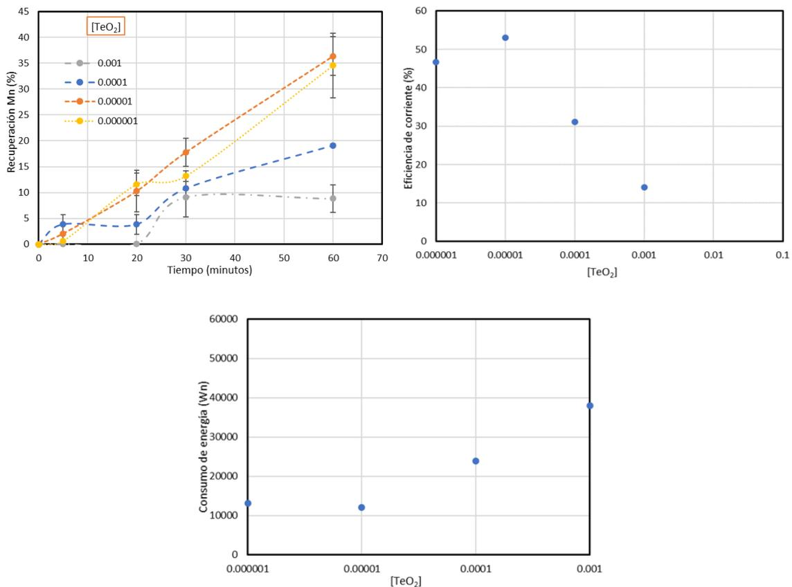
**Figura 2. Recuperación de Mn, eficiencia de corriente y consumo de energía en función de la concentración de  $\text{TeO}_2$ . Densidad de corriente=600 A/m<sup>2</sup>,  $[\text{Mn}^{+2}]$ =0.27,  $[(\text{NH}_4)_2\text{SO}_4]$ =0.9.**
