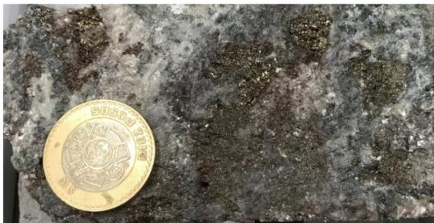
**Figura 7. Fotografía de una muestra de núcleo de un intrusivo porfídico mineralizado. Debido a la alteración hidrotermal, la mineralogía es difícil de distinguir en esta imagen. Los parches de sulfuros arriba y a la derecha de la moneda son principalmente de calcopirita y pirita.**
