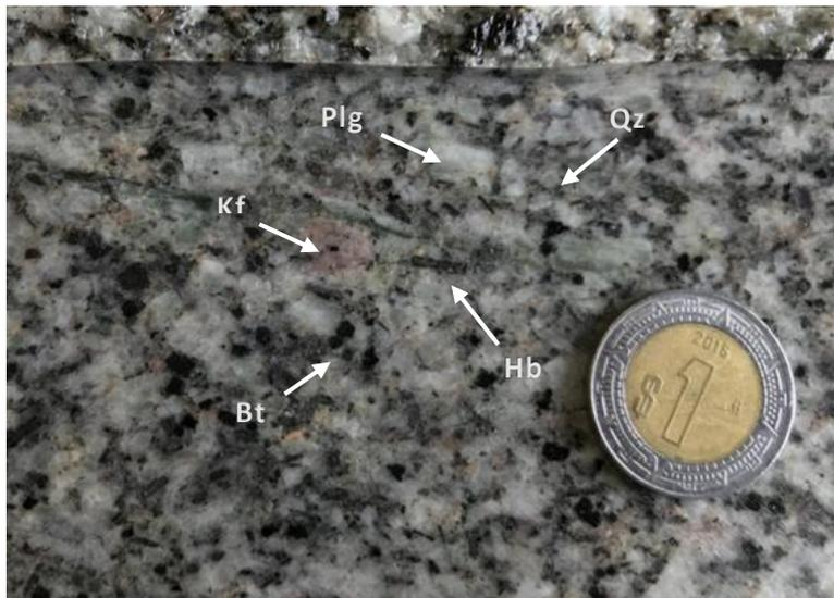
**Figura 6. Fotografía del intrusivo cuarzomonzonítico tomada de una muestra de núcleo de barrenación, mostrando un aspecto de la mineralogía. Plg (plagioclasa); Qz (cuarzo); Kf (feldespato potásico); Hb (hornblenda); Bt (biotita).**
