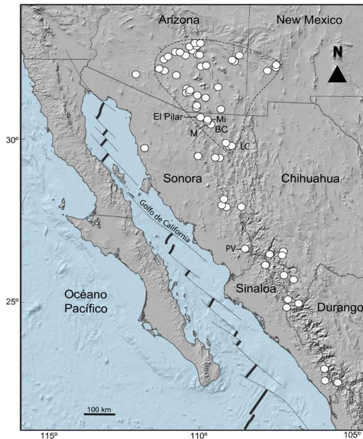
**Figura 1. Localización de la porción principal del cinturón de pórfidos de cobre del suroeste de Norteamérica, mostrando los depósitos más importantes (círculos blancos). La línea punteada limita la zona del gran clúster. BC: Buenavista del Cobre; LC: La Caridad; M: María; Mi: Milpillas; PV: Piedras Verdes.**
