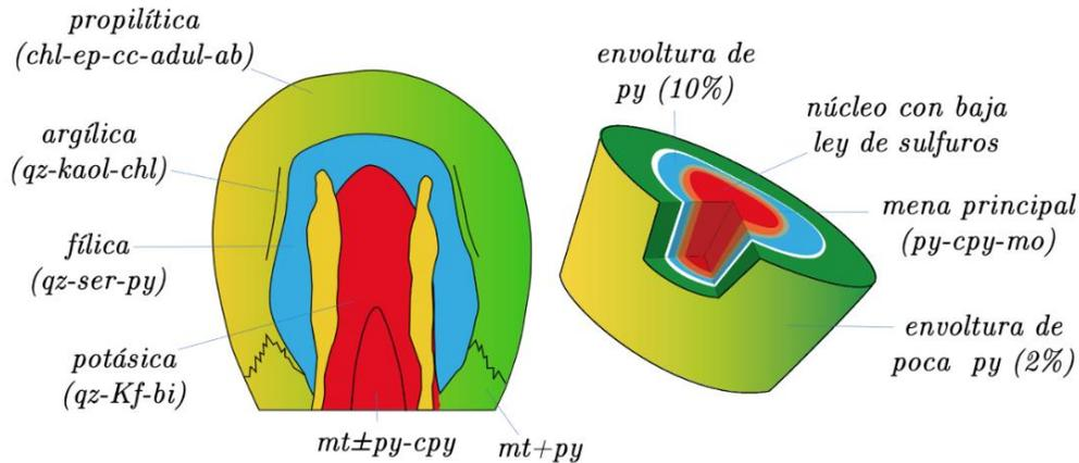
**Figura 2. Modelo tradicional de los depósitos tipo pórfido de cobre, mostrando el zonamiento lateral de la alteración (izquierda) y de los minerales de mena (derecha). Chl (clorita), Ep (epidota), cc (calcocita), adul (adularia), ab (albita), qz (cuarzo), kaol (kaolinita), ser (sericita), py (pirita), Kf (feldespato potásico), bi (biotita), cpy (calcopirita), mo (molibdenita) y mt (montmorillonita).**
