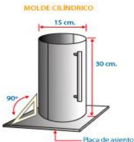
Figura 4. Medidas de la probeta. Fuente: Elaboración propia
