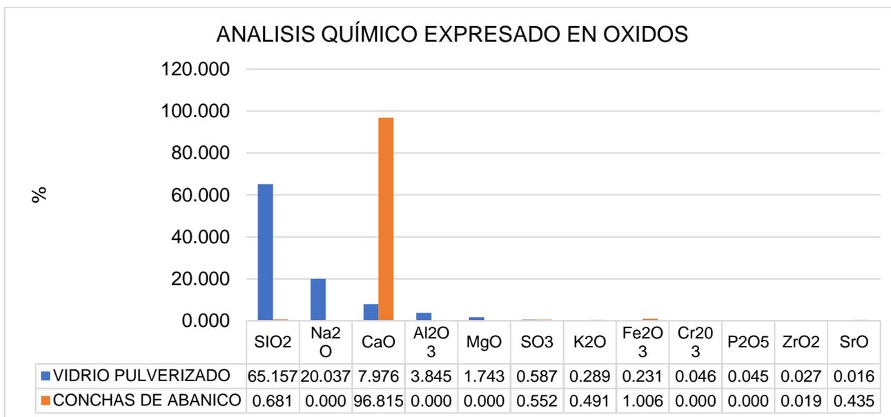
**Figura 3. Comparación de vidrio pulverizado y conchas de abanico calcinadas expresados en óxidos.** Fuente: elaboración propia
