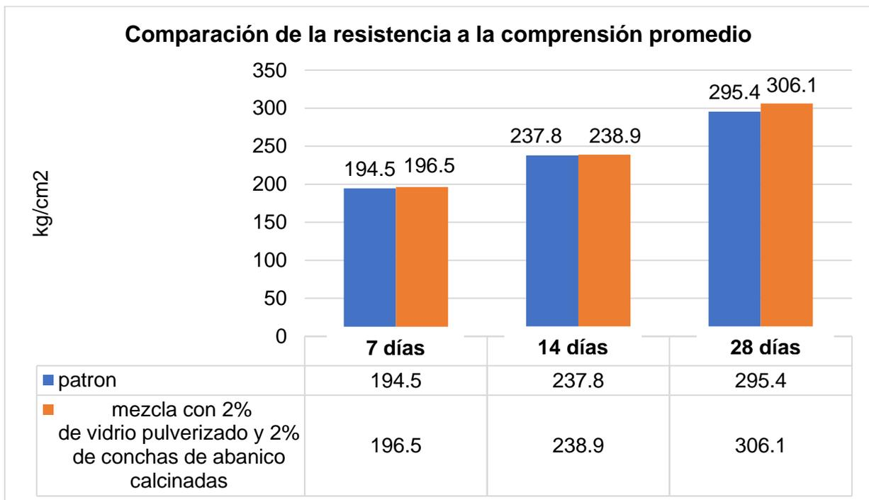
**Figura 5. Resultados promedio de los 7, 14 y 28 días en los ensayos a compresión** Fuente: Elaboración propia
