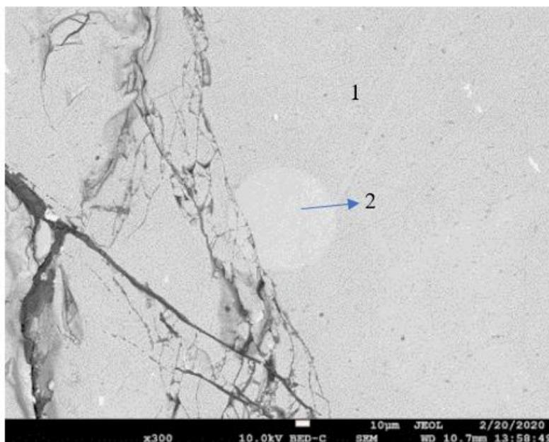
**Figura 5. Micrografía a 300x tomada en FESEM del electrodo de calcopirita resultante al llevar a cabo una polarización catódica a -2.2 V vs SHE con una solución de ácido acético 3 M en donde se muestran dos zonas con diferente tonalidad.**
