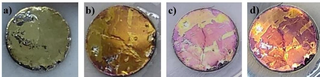
**Figura 3. Comparación de la capa de producto formada durante la reducción de la calcopirita en las voltametrías lineales partiendo del OCP a -0.8 V vs SHE con diferente concentración de ácido acético a) 0.5 M, b) 1 M, c) 2 M y d) 3 M**
