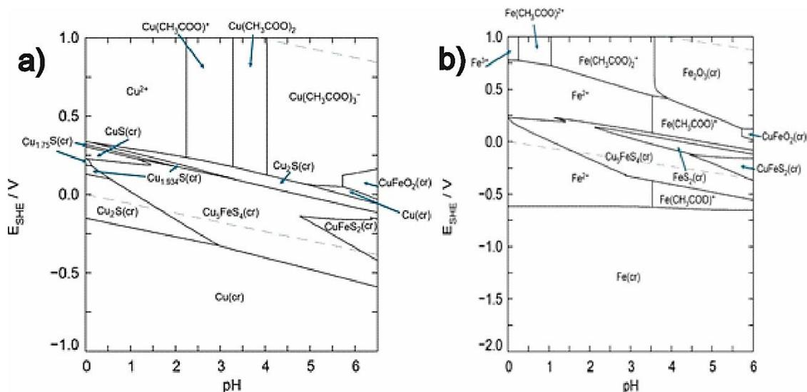
**Figura 1. Diagrama de Pourbaix del sistema  $\text{CuFeS}_2\text{-CH}_3\text{COO}^- \text{- H}_2\text{O}$  que muestra las zonas de estabilidad de las especies de a) Cu y b) Fe a una temperatura de**
