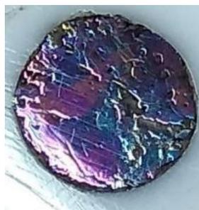
**Figura 6. Capa formada en la superficie de la calcopirita durante la polarización catódica partiendo del OCP a - 2.2 V vs SHE con una solución de ácido acético 3 M con pH de 5.10.**
