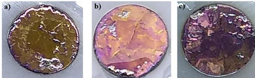
**Figura 4. Comparación de la capa de producto formada durante la reducción de la calcopirita en las voltametrías lineales partiendo del OCP a -2.2 V vs SHE con diferente concentración de ácido acético a) 0.5 M, b) 1 M y c) 2 M.**
