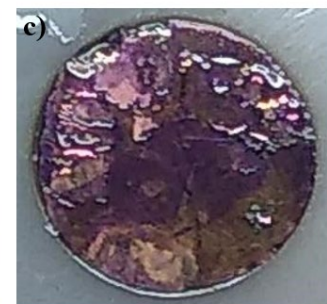
Figura 4. Comparación de la capa de producto formada durante la reducción de la calcopirita en las voltametrías lineales partiendo del OCP a -2.2\text{ V vs SHE} con diferente concentración de ácido acético a) 0.5\text{ M} , b) 1\text{ M} y c) 2\text{ M} .
