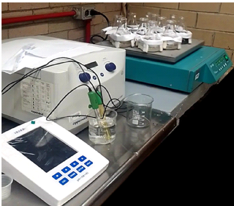
Figura 1. Reactor experimental con el multiparámetro para toma de datos y muestras.
