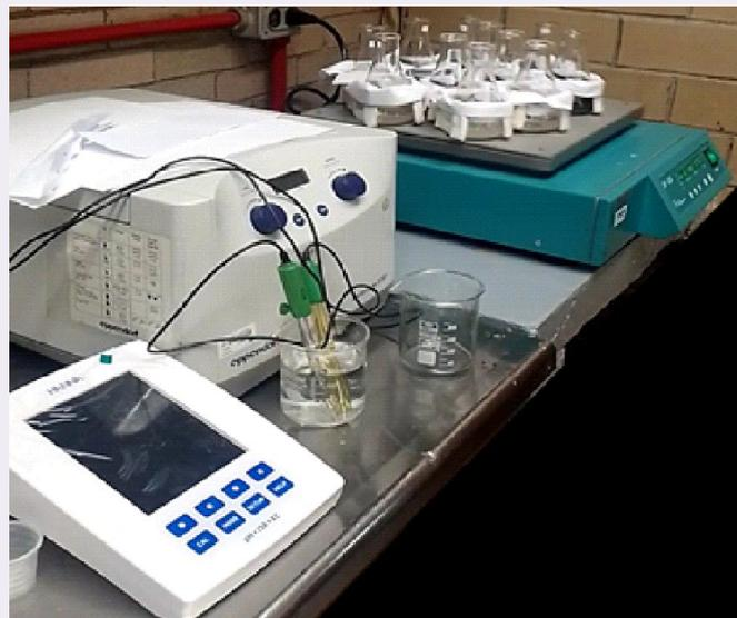
Figura 1. Reactor experimental con el multiparámetro para toma de datos y muestras.
