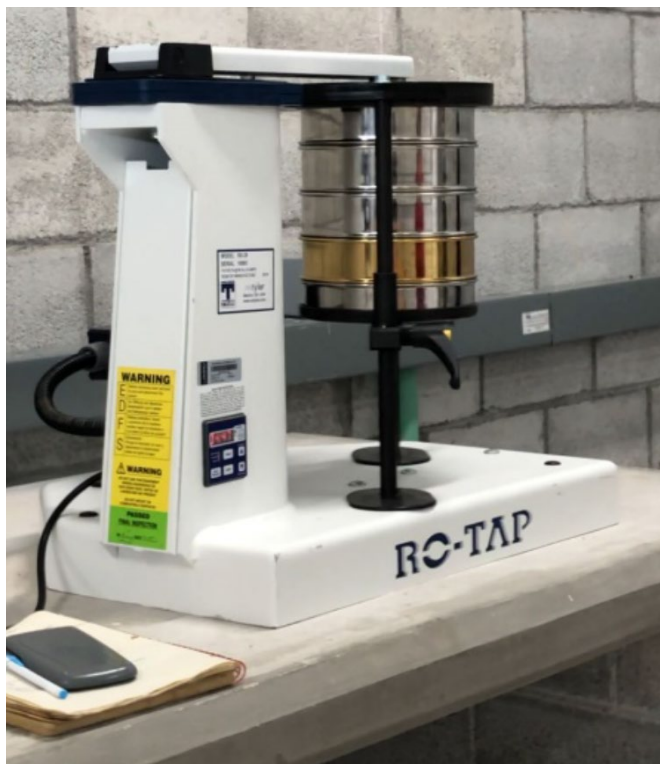
Figura 3. Set experimental para granulometría por tamizaje.
