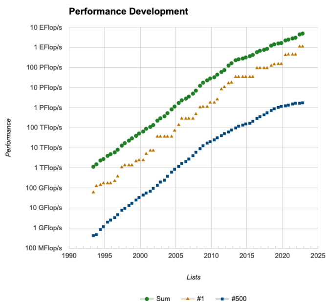
Figura 1. Rendimiento de las 500 supercomputadoras más potentes del mundo; las #500 se representan en cuadros azules, las #1 en triángulos amarillos y el desempeño total o la #suma en cuadros verdes. El eje vertical muestra el desempeño medido en Flop/s y el eje horizontal el año de la publicación de la lista (Imagen tomada del portal TOP500 the List https://top500.org ).
