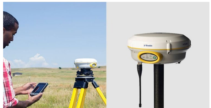
Figura 1. Herramienta Trimble R4 utilizada para la recolección de ubicaciones de la flora.
