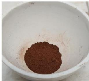
**Figura 7. Partículas de maghemita sintetizadas por tratamiento térmico**
