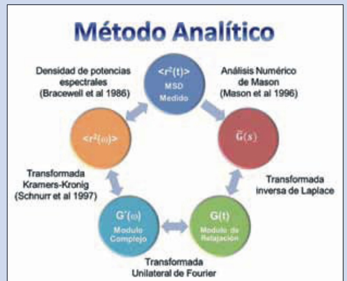
Figura 4. Esquema de obtención de los módulos viscoelásticos a partir del desplazamiento cuadrático medio.
