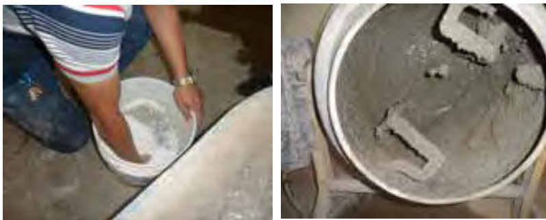
Figura 1. Mezcla de los materiales aligerados con perlita sintética
