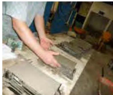
Figura 4. Elaboración de muestras cuadradas en estado fresco
