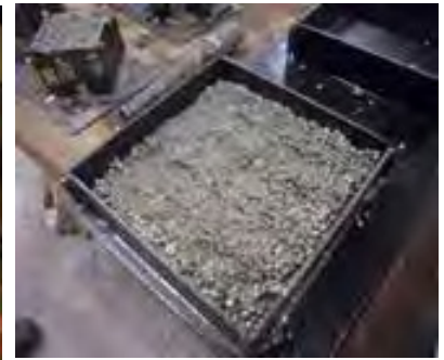
Figura 4. Elaboración de muestras cuadradas en estado fresco
