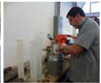
Figura 2. Pruebas de fluidez y contenido de aire.
