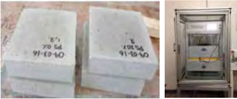
Fig.6. Muestras y equipo para medir conductividad térmica.
