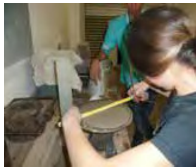
Figura 2. Pruebas de fluidez y contenido de aire.
