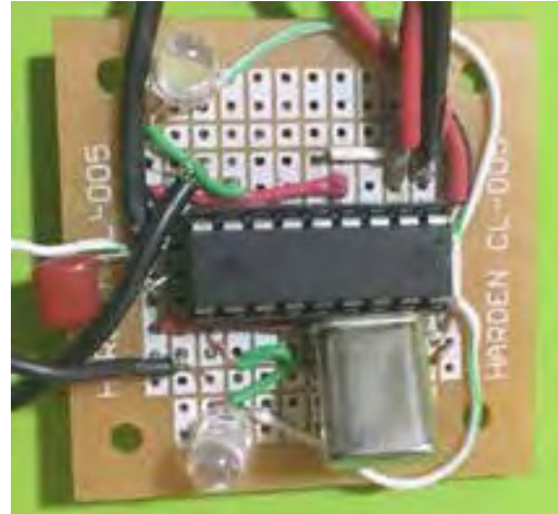
Figura 8. Montaje físico del sensor ultrasónico con el PIC 16F84a.
