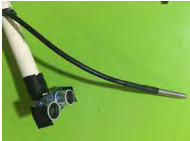
Figura 9. Montaje físico sensor ultrasónico y sensor de temperatura.
