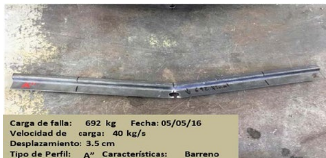
Imagen 4.2. Muestra de ensaye en Perfil tipo A Muesca.
