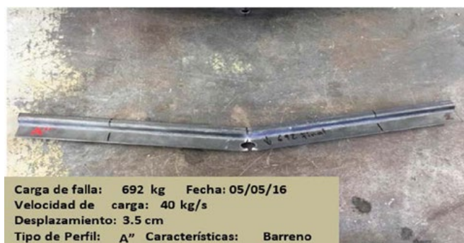
Imagen 4.1. Muestra de ensaye en Perfil tipo A" Barreno
