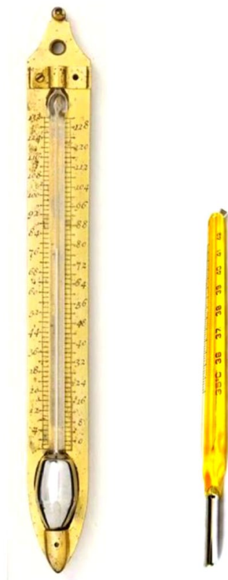
Figura 1. El termómetro de mercurio apenas experimentó cambios en 300 años. Izquierda: Termómetro original de Fahrenheit; derecha: Termómetro clínico moderno. Imagen obtenida de The Linda Hall Library of Science, Engineering & Technology. https://www.lindahall.org/daniel-fahrenheit/ [7].
