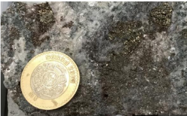
Figura 7. Fotografía de una muestra de núcleo de un intrusivo porfídico mineralizado. Debido a la alteración hidrotermal, la mineralogía es difícil de distinguir en esta imagen. Los parches de sulfuros arriba y a la derecha de la moneda son principalmente de calcopirita y pirita.
