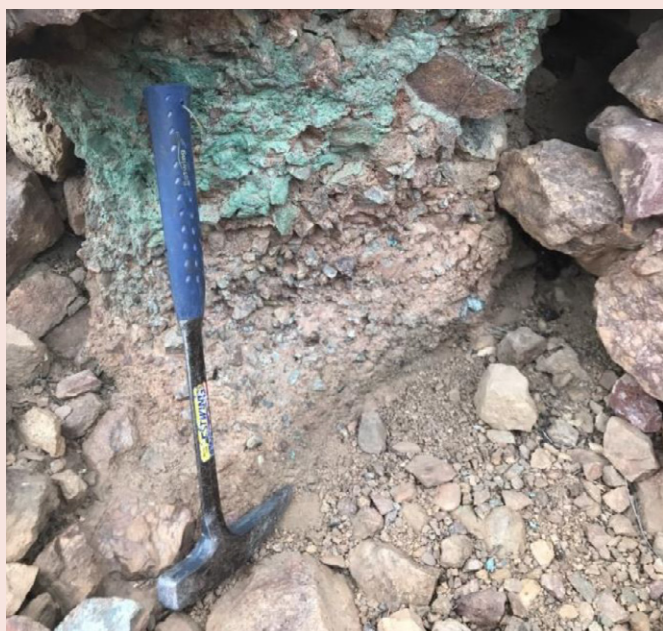
Figura 9. Fotografía en uno de los afloramientos del conglomerado del Mioceno mostrando mineralización de cobre en forma de malaquita cubriendo parte de los fragmentos de roca.
