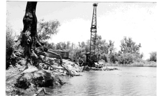
Figura 5. Explotación de recursos pétreos, dragado de arena y grava. Nótese la afectación en el árbol de álamo. Septiembre 2003
