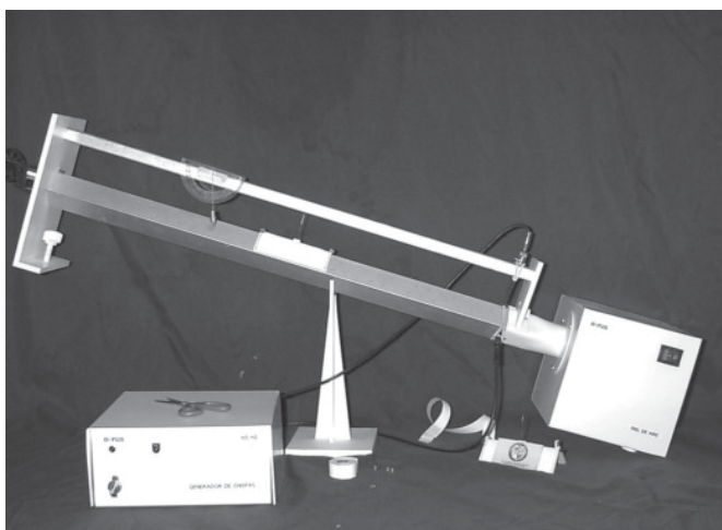
Figura 1. En la fotografía se muestra el riel de aire en posición inclinada. Se puede observar los accesorios y el generador de chispa.
