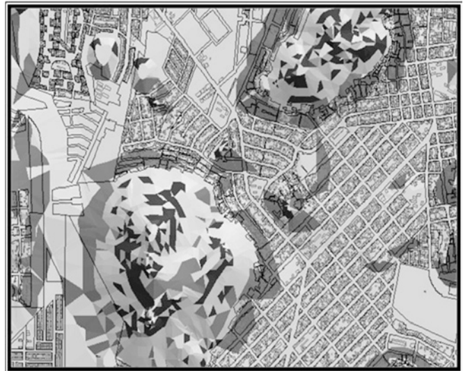
Figura 3. Imagen que muestra una ventana del plano de pendientes obtenido a partir del Sistema de Información Geográfica y en donde se aprecia como las zonas urbanizadas ha invadido áreas con un alto grado de inclinación.
