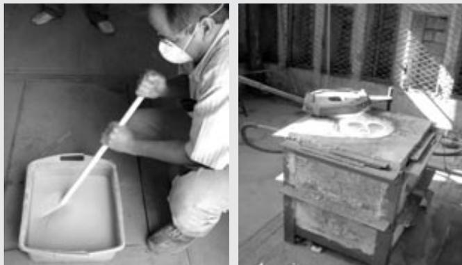
Figura 1. Preparación de la mezcla vitrificable y horno de fundición en funcionamiento.
