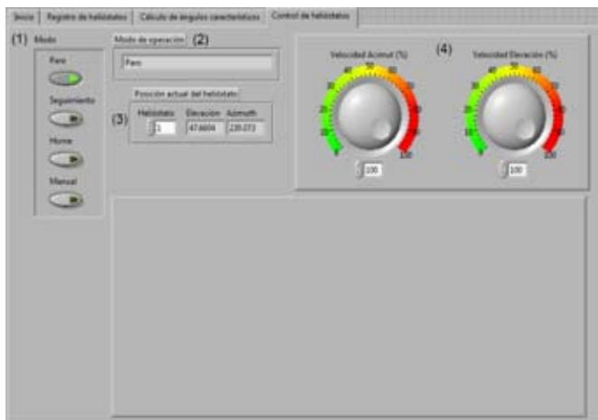
Figura 9. Panel frontal con controles unificados
