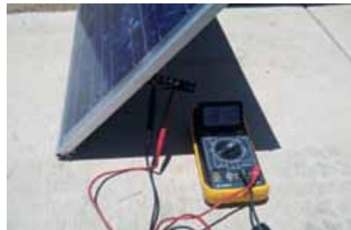
Figura 9. Prueba de voltaje ( $V_{oc}$ )
