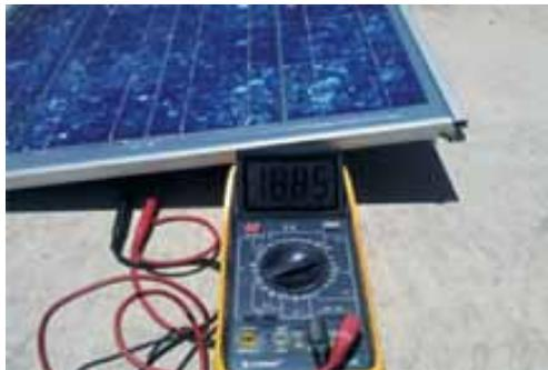
Figura 7. Prueba de voltaje ( $V_{oc}$ )
