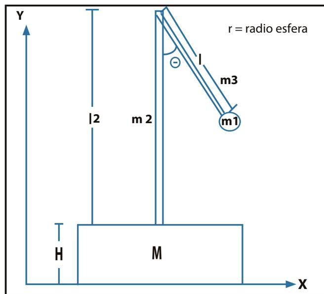
Figura 1. Esquema del péndulo móvil.
