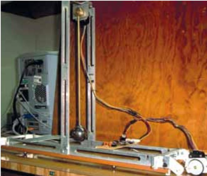
Figura 2. El péndulo móvil construido.
