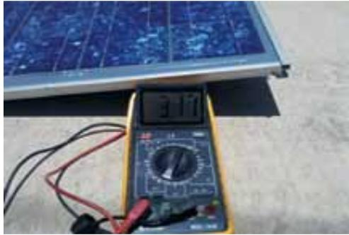
Figura 6. Prueba de corriente ( $I_{sc}$ )
