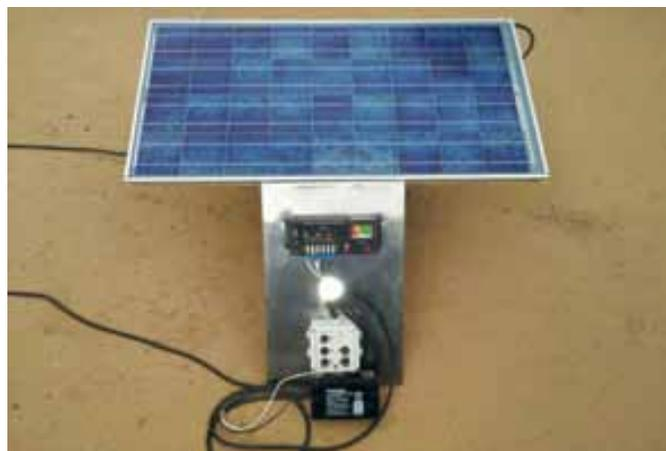
Figura 13. Sistema fotovoltaico de iluminación solar.
