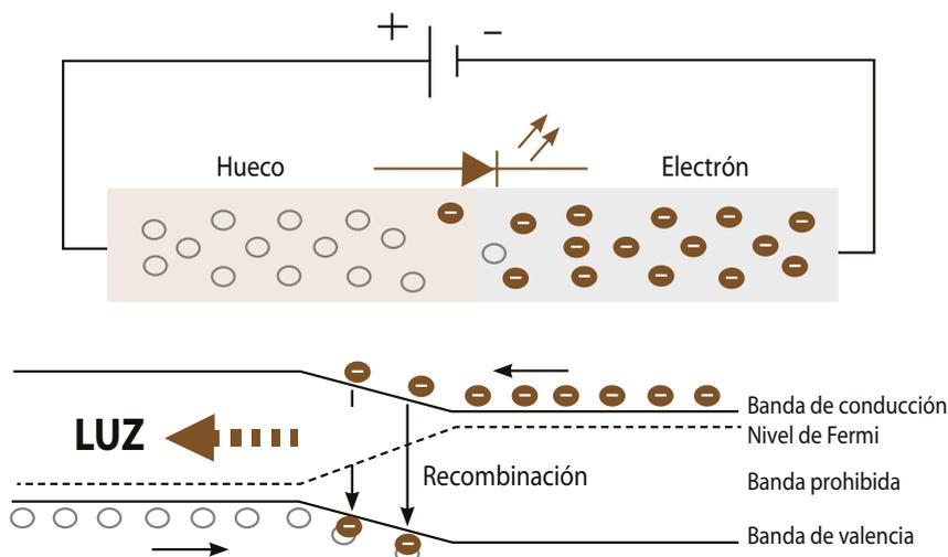
Figura 1. Luz emitida por la recombinación electrón-hueco.
