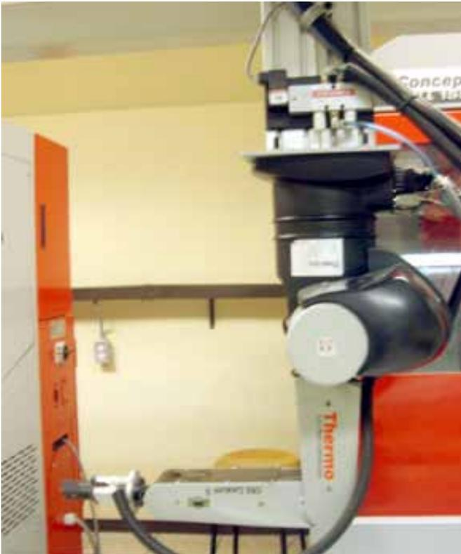
Figura 2. El robot tipo Gantry de seis ejes.
