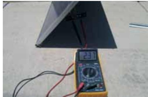
Figura 8. Prueba de corriente ( $I_{sc}$ )
