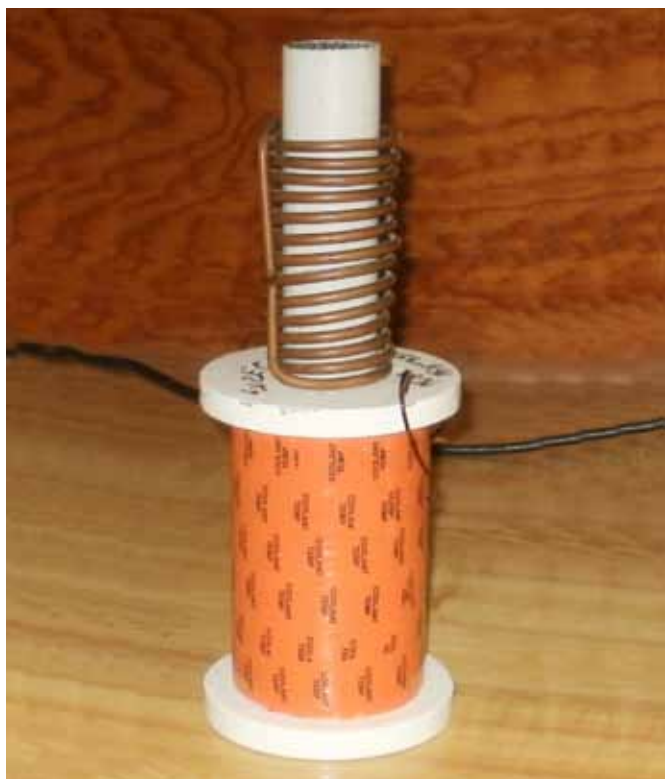
Figura 6. Transformador de corriente.
