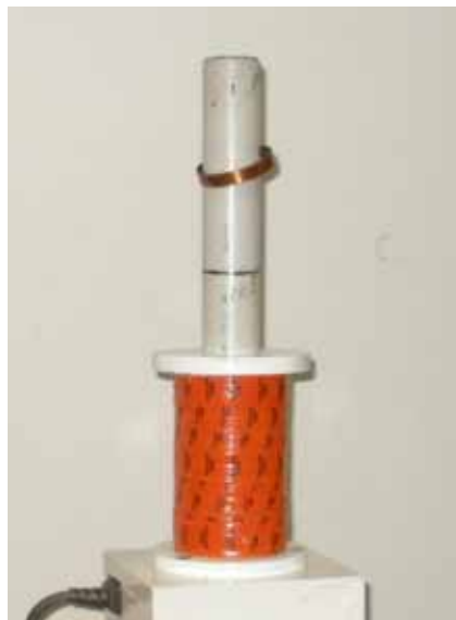
Figura 2. Aro levitador en la Bobina de Thomson.
