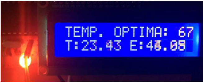
Figura 15. Montaje físico del control de temperatura con el PIC 16F877
