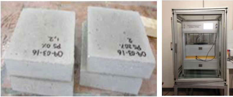
Fig.6. Muestras y equipo para medir conductividad térmica.
