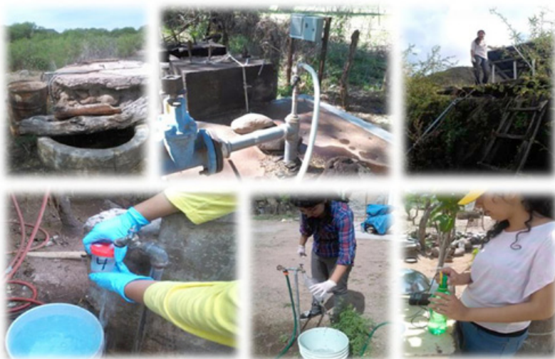
Figura 3. Puntos de muestreo: pozo de energía solar, pozo de energía eléctrica, depósito de agua, obteniendo muestra en la casa cercana al depósito, casa situada en el punto medio del poblado, casa lejana al depósito (de izquierda a derecha, arriba a abajo).
