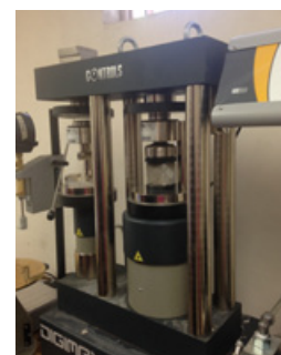
Fig.5. Muestras y equipo para medir esfuerzo a la compresión.
