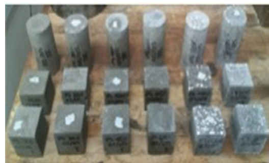
Fig.5. Muestras y equipo para medir esfuerzo a la compresión.
