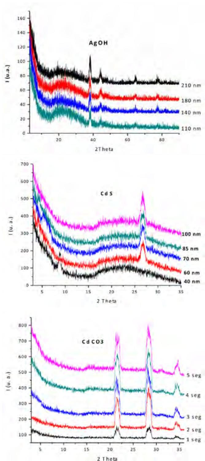
**Figura 5.** Los difractogramas de AgOH y CdS representan muestras de distintos espesores como se señala en las gráficas, mientras que en los difractogramas del CdCO<sub>3</sub> representan a una sola muestra medida con diferente velocidad como es señalado.
