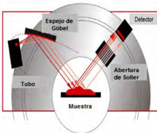
Figura 1. Esquema de la configuración con haz paralelo producido por el espejo Gobel, se utiliza para polvos y superficies irregulares con la configuración Bragg-Brentano  $\theta:2\theta$ , así como también para medir películas con haz rasante  $2\theta$  y  $\theta$  fijo.
