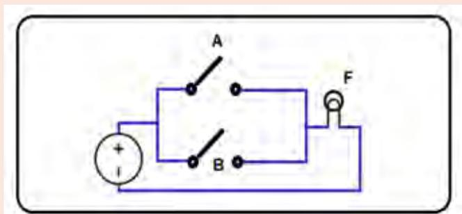
Figura 11. Conexión en paralelo.
