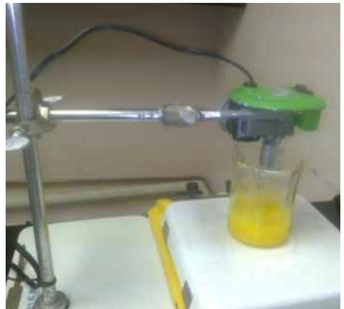
Figura 3. Equipo utilizado para realizar baño químico.
