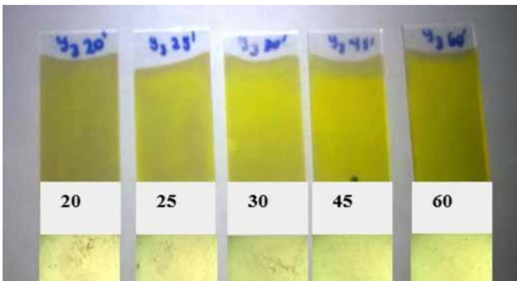
**Figura 4. Películas CdS y tiempo de deposición.**
