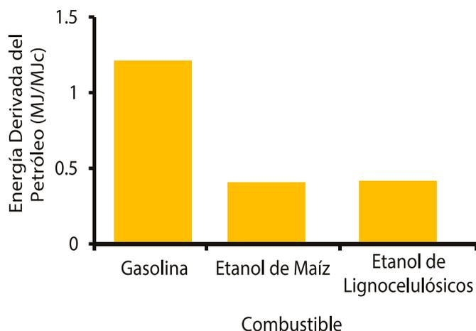
Figura 4. Energía derivada del petróleo requerida para producción de combustibles a partir de diferentes materias primas [12-14].
