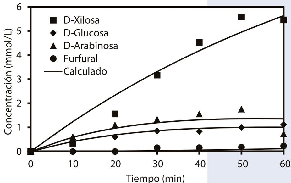
Figura 2. Valores experimentales y calculados de monómeros producidos durante la hidrólisis ácida de *Cenchrus ciliaris*. Condiciones experimentales: 0.16 mm, 0.15 M  $H_2SO_4$ , 120 °C.
