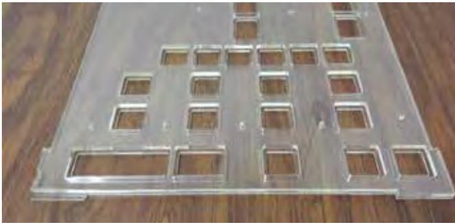
Figura 21. Placa cajón para elementos deslizantes.
