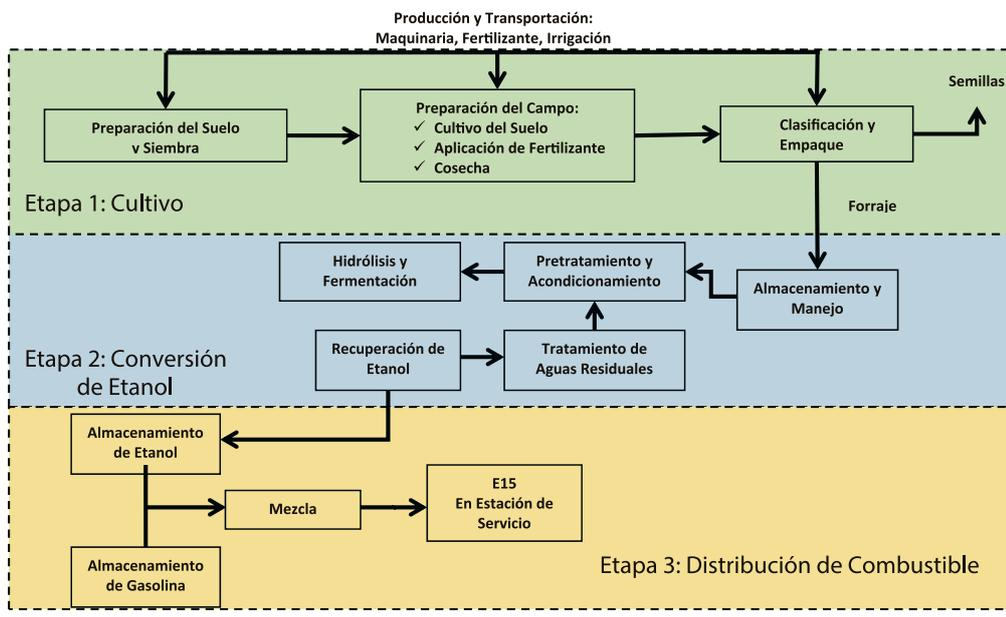
Figura 1. Esquema global de producción de etanol a partir de *Cenchrus ciliaris*.
